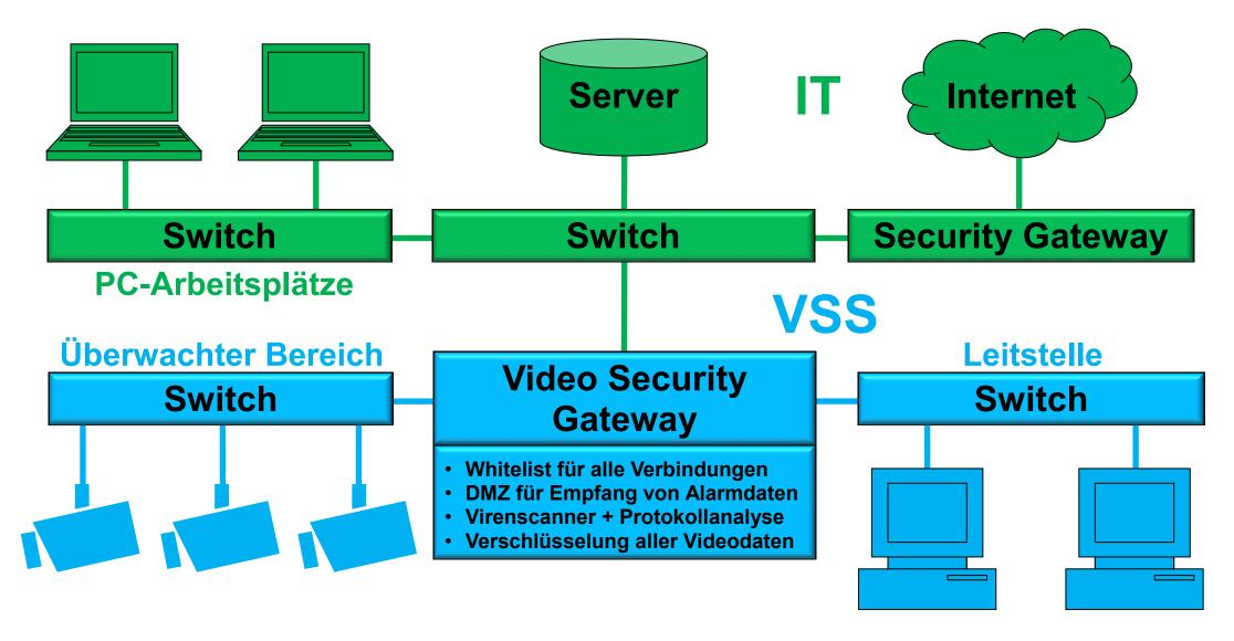
Kaskadierte Sicherheit: Ein Video Security Gateway sichert die Videoanlage gegenüber dem Unternehmensnetzwerk ab
